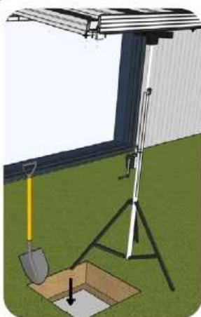
**6.3** Graben Sie ein Loch von 20 bis 30 cm aus. Legen Sie eine Fliese an die Stelle, an der der Pfosten stehen wird. Stellen Sie den Pfosten waagrecht auf. Befestigen Sie den Pfosten mit Beton und festen Schrauben.
